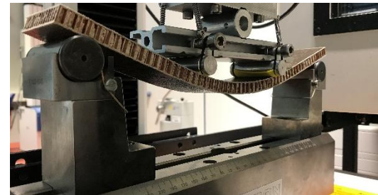
Probekörper im 4-Punkt-Biegeversuch
