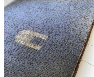
integrierter piezoelektrischer Sensor mit Kontaktierung & Prinzipdarstellung
